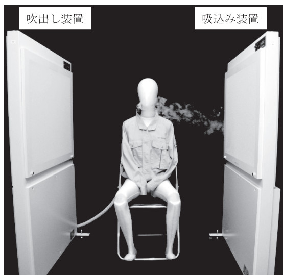
図1 一方向流の簡易局所排気としての使用例
