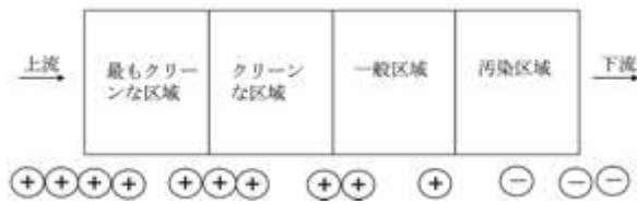
図7 気流制御による室間圧力差の確保
