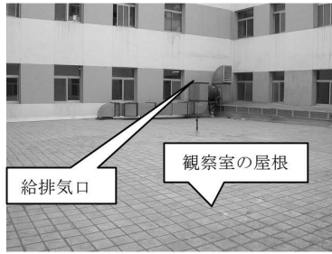
図6 診察室屋上給排気口の配置
