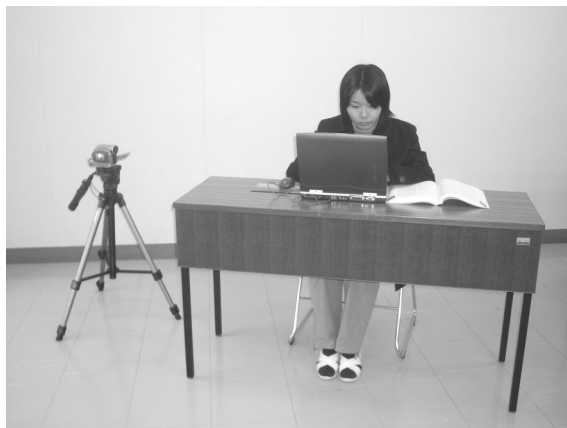
図1a VDT 作業中の瞬目回数の計測
