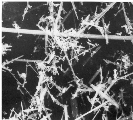
図1 アモサイト・アスベスト (amosite) の走査電子顕微鏡写真
