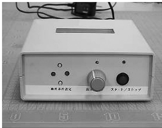
図3 振動電話信号出力装置の前面パネル
