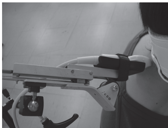
図3 定荷重ばねを取り付けたプロープホルダー
